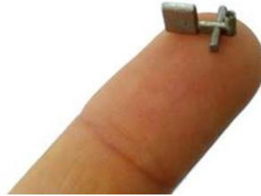
Grâce à une technologie d'impression 3D de pointe, la sonde miniature la plus avancée pour les mesures de débit dans les radiateurs voit enfin le jour. Avec une taille de seulement 10 mm et avec une tête Kiel de 1,6 mm de diamètre, cette sonde réduit au minimum l'obstruction du flux.
